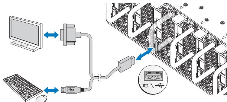
El conector de la parte frontal del sistema tiene un ícono que indica qué cable debe conectarse. Conecte un teclado, un ratón o un monitor (opcional).
