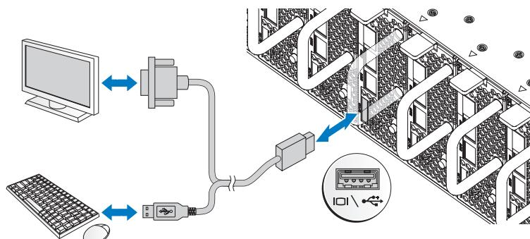
O conector na parte frontal do sistema tem um ícone indicando qual cabo deve ser conectado. Conecte um teclado, mouse ou monitor (opcional).
