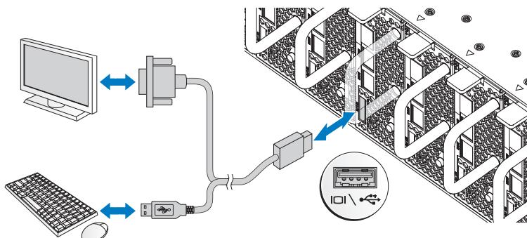
Le connecteur situé à l'avant de votre système comporte une icône indiquant quel câble brancher. Connectez un clavier, une souris ou un moniteur (facultatif).
